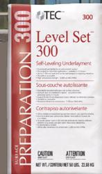
Ideal para trabajos rápidos, TEC Level Set 300 le permite alisar sustratos rápidamente sin sacrificar el rendimiento. Este contrapiso autonivelante de alta calidad, a base de aluminato de calcio, le brinda una superficie plana, extremadamente suave y durable sobre la que se puede **caminar en 2-3 horas**. Y puede usted instalar revestimientos para pisos sensibles a la humedad en tan solo 16-24 horas.
